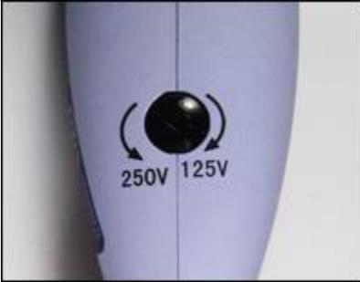
Sur cette image, vous pouvez voir que certains appareils disposent d'un commutateur à utiliser entre les tensions supérieures et inférieures. Cela peut être utilisé à l'étranger avec seulement un **adaptateur de prise**, mais n'oubliez pas d'inverser le commutateur!
