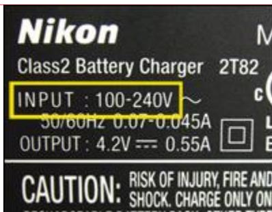
La plupart des appareils électroniques ont une étiquette proéminente qui ressemble à cette image. Sur cet appareil (un chargeur de batterie d'appareil photo), vous pouvez voir qu'après « Input », il est écrit « 110 - 240 volts », ce qui signifie qu'il peut être utilisé avec n'importe quelle tension dans cette plage, y compris la norme de 110 volts au Canada ou la norme de 220 à 230 volts dans une grande partie de l'Europe. Tout ce dont vous aurez besoin est un adaptateur de prise.
