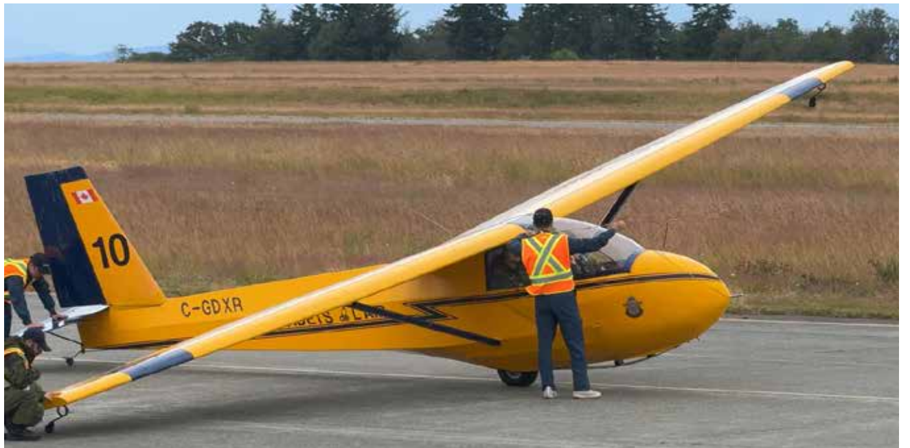
Ground personnel prepare for a tow-plane launch of C-GDXR, one of the two-seat Schweizer SGS 2-33A air cadet gliders. Le personnel au sol prépare le décollage du C-GDXR, l'un des planeurs biplaces Schweizer SGS 2-33A destinés aux cadets de l'air, à l'aide d'un avion remorqueur.
